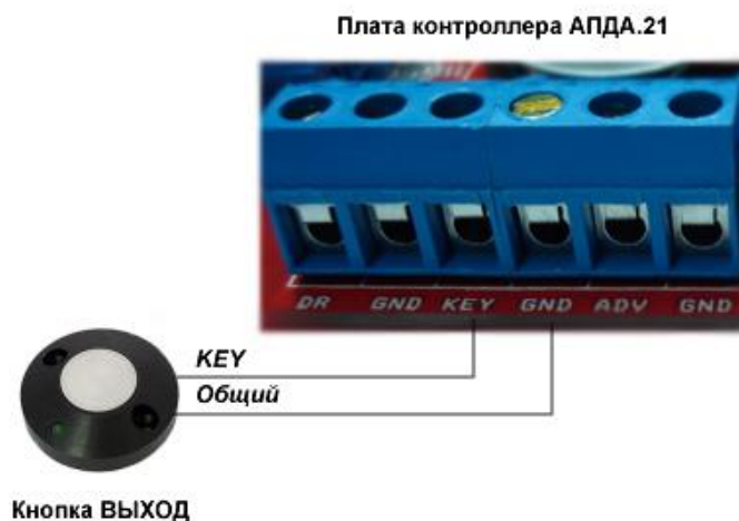
Рисунок 4 - Схема подключения кнопки "Выход"
