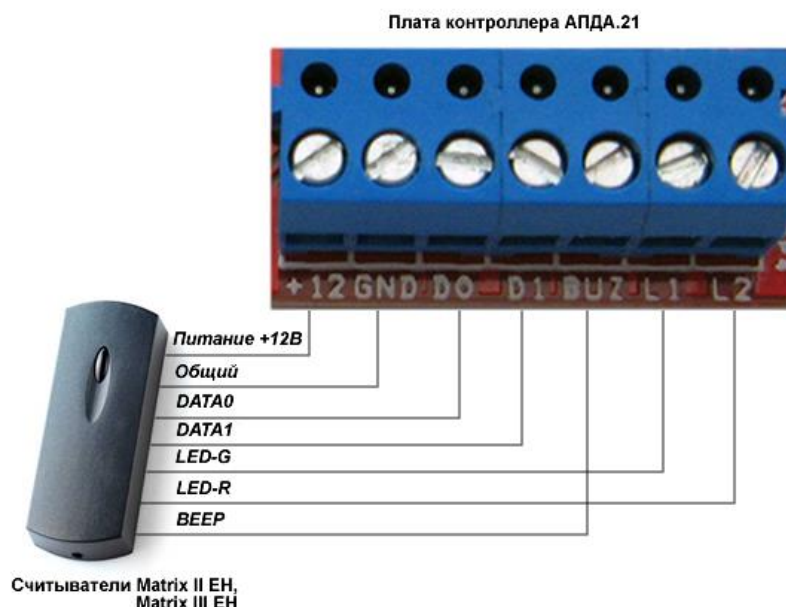
Рисунок 3 – Схема подключения считывателей
