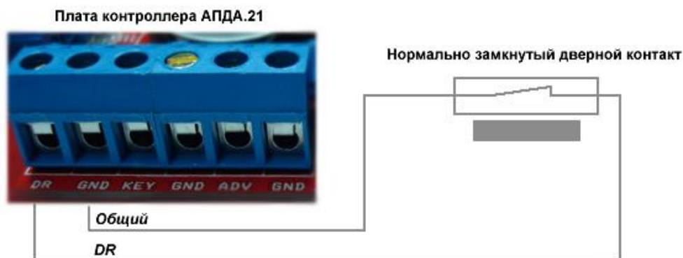
Рисунок 5 – Схема подключения дверного контакта
