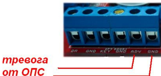
Рисунок 24 - Подключение внешнего сигнала тревоги
